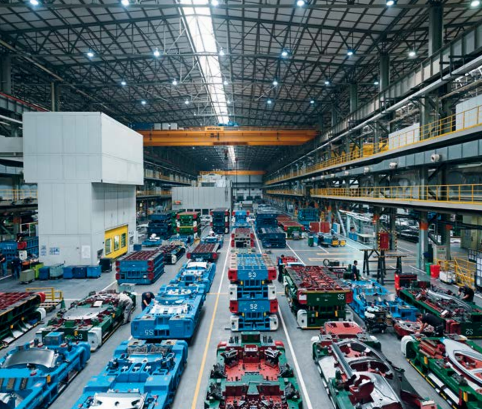
Die neue Pressenhalle von FAW-Volkswagen in Changchun, China, ist fast 26.000 Quadratmeter groß und 20 Meter hoch. Sie muss schließlich bis zu drei riesige Pressenlinien von Schuler zur Herstellung von Karosserieteilen aufnehmen.
