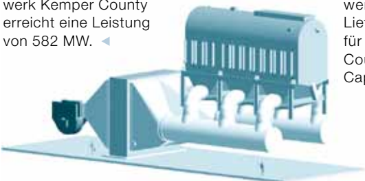
▲ BRAUNKOHELTROCKNUNG. Fließbetttrockner für das Gas- und Dampfturbinenkraftwerk Kemper County, USA.
